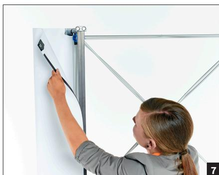
Fixez les bandes imprimées au système à l'aide des aimants supérieurs disposés sur les impressions.
